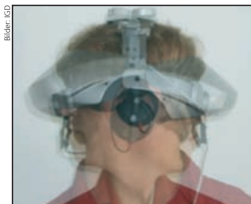
VR-Diagnose: Mit Datenbrille und Schmerzsensoren wird die Schwere eines Schleudertraumas festgestellt.
